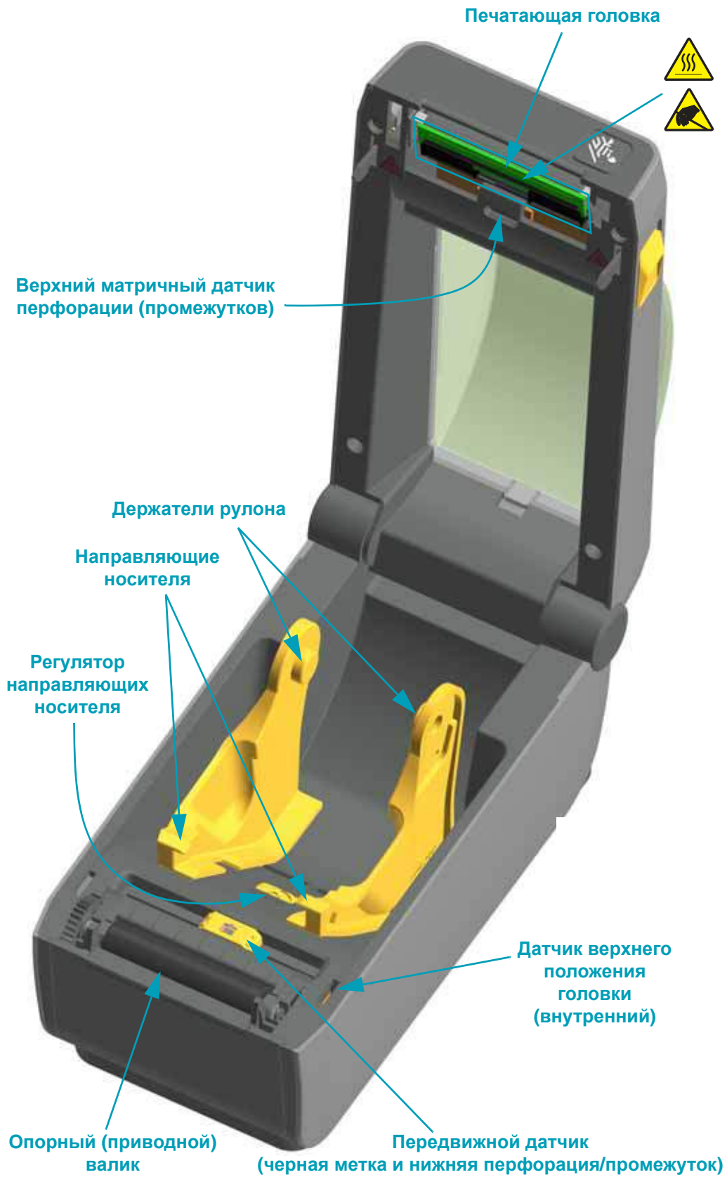
Рис. 2 • Компоненты принтера (продолжение)
