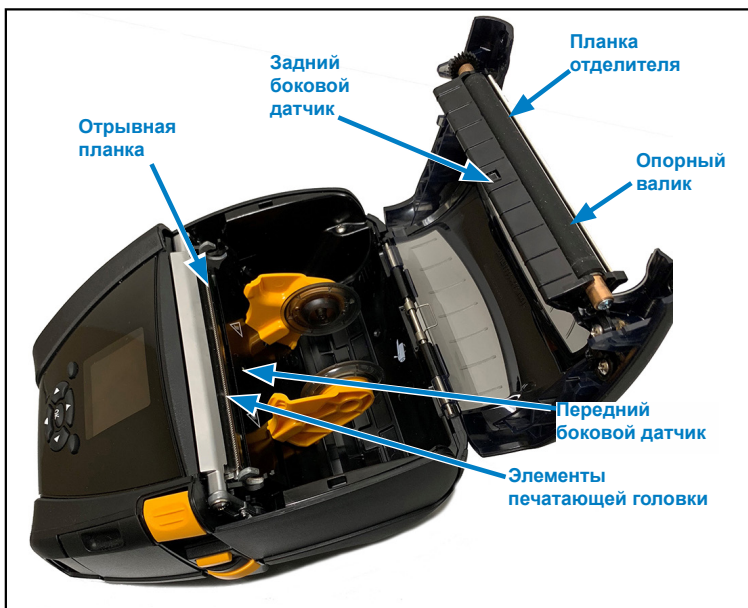
Рис. 33 • Очистка принтера ZQ630 (носитель с подложкой)
