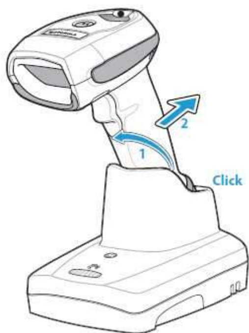
Рисунок 1-13 Извлечение сканера из стационарной базовой станции
